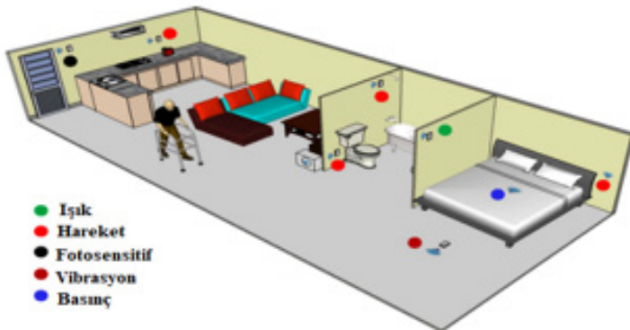
Şekil 1. Ortam sensörleri ve ev tabanlı rehabilitasyon sistemi örneği
