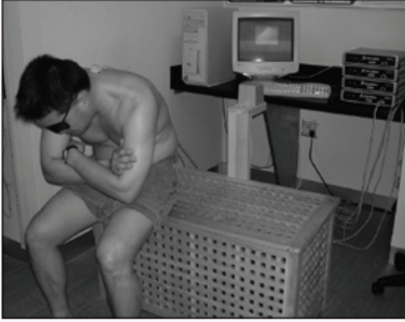
Resim 2: Gövde pozisyon hissinin Flock of Birds sistemiyle değerlendirilmesi (2).
